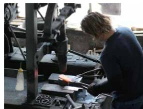
伝統の火造り鍛造技術で、薄くて強い刃物に仕上げる
